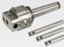
D/25 - D/40 Testa per alesatura con spostamento centesimale, C.M. 4 o 3 - ø di alesatura 5-230 - corredata di 3 baren e chiavi di servizio. Tête excentrique à alésage et à chariot Cône Morse 4 ou 3 - Diamètre d'alésage 5-230 - équipée avec 3 barres d'alésage et clefs de service. Excentric head for boring and tuning Morse taper 4 or 3 - Boring diameter 5-230 - fitted with 3 borings and servicing tools. Ausdrekköpfe zum Ausbohren und Drehen Morse Kegel 4 oder 3 - Exzenterkopf zum Ausbohren 5-230 mm - mit 3 Bohrer und Bedienungsschlüssel.
